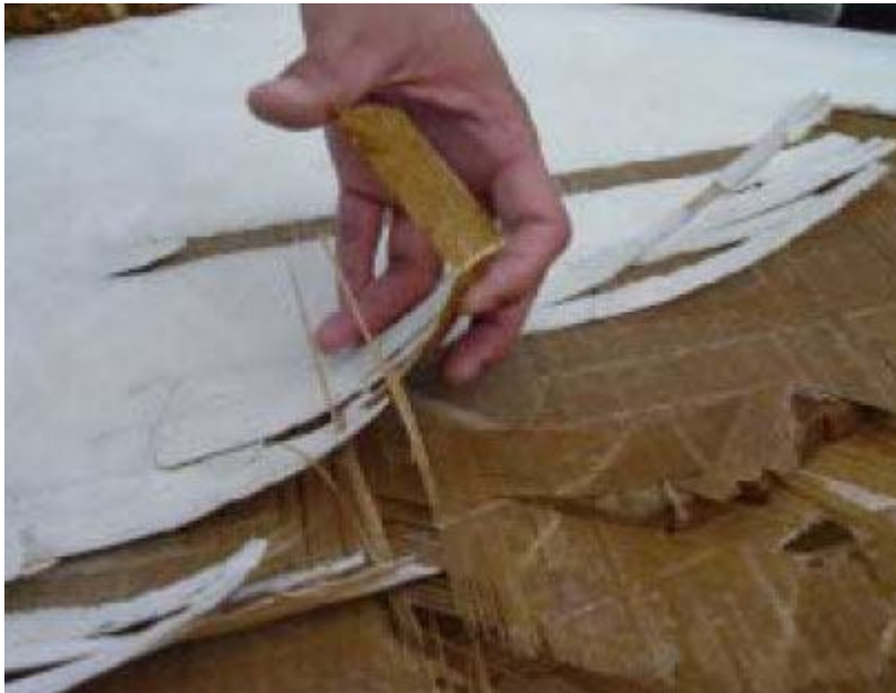
图5: 鼓包断裂后的二次性破坏
