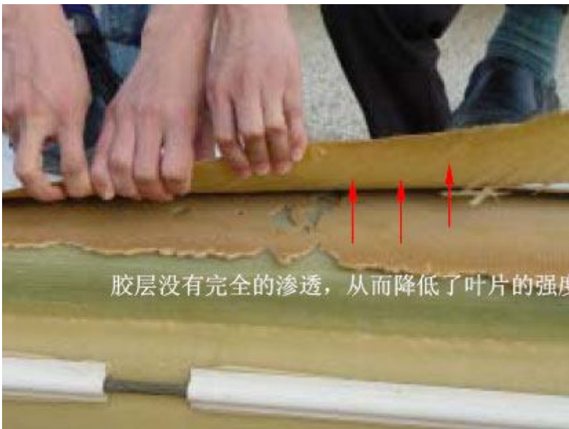
图8: 主梁与蒙皮粘胶或制造质量的缺陷
