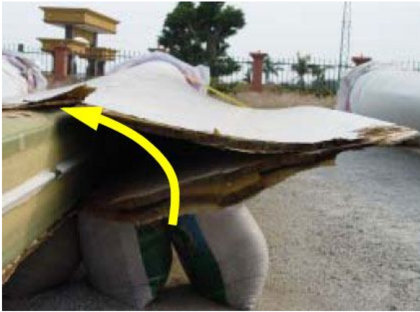
图4: 蒙皮断裂之后的二次性破坏
