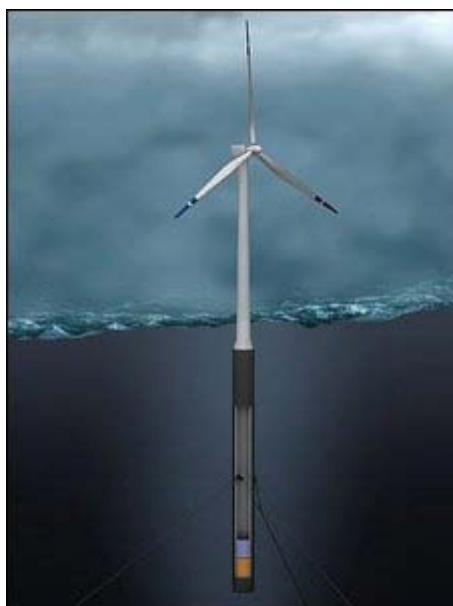
世界首座浮式风电机组 Hywind 在海下的部分
