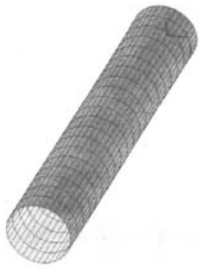
图 2 玻璃钢夹砂管有限元分析的力学模型
