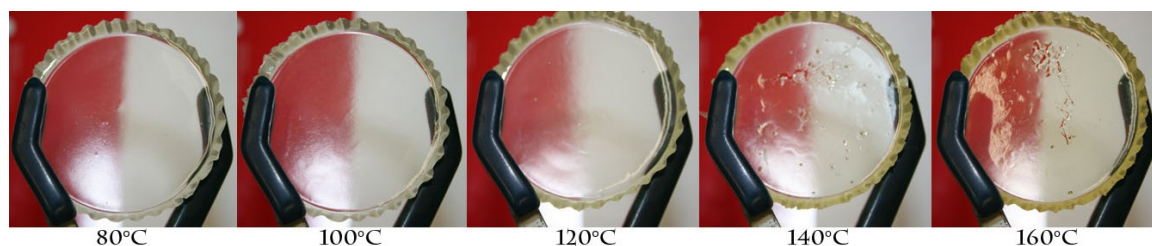
图 3. 不同反应温度时 A0-3 对双酚 A 体系颜色的影响
