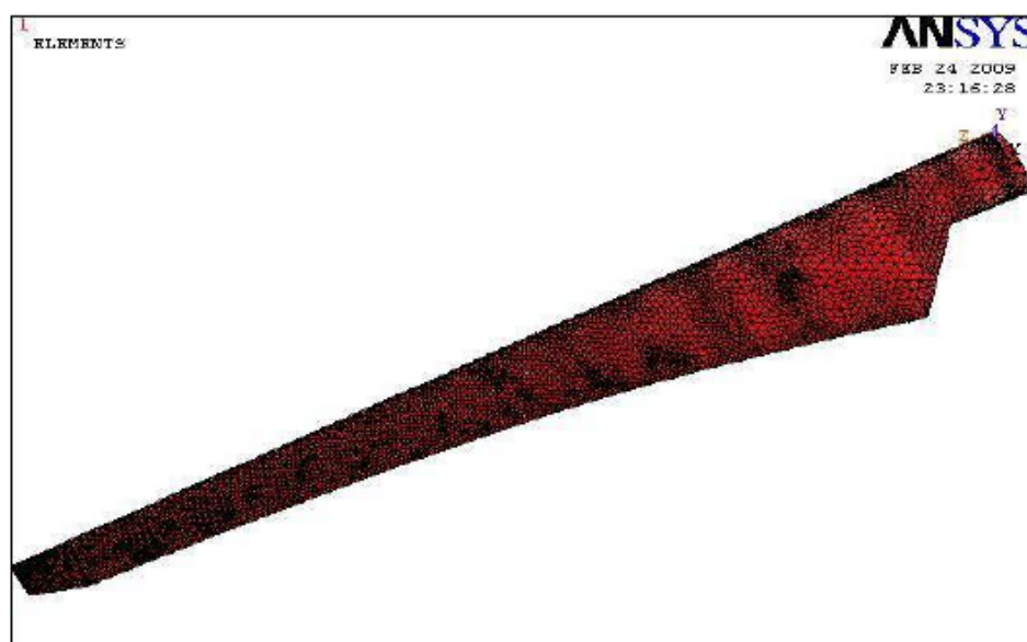
图 5.3 叶片有限元网格模型
